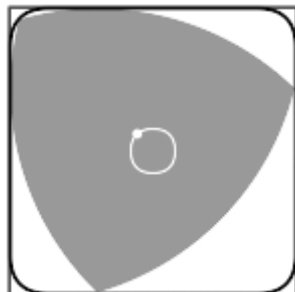
Рис.3. Качание треугольника Рёло по квадрату
